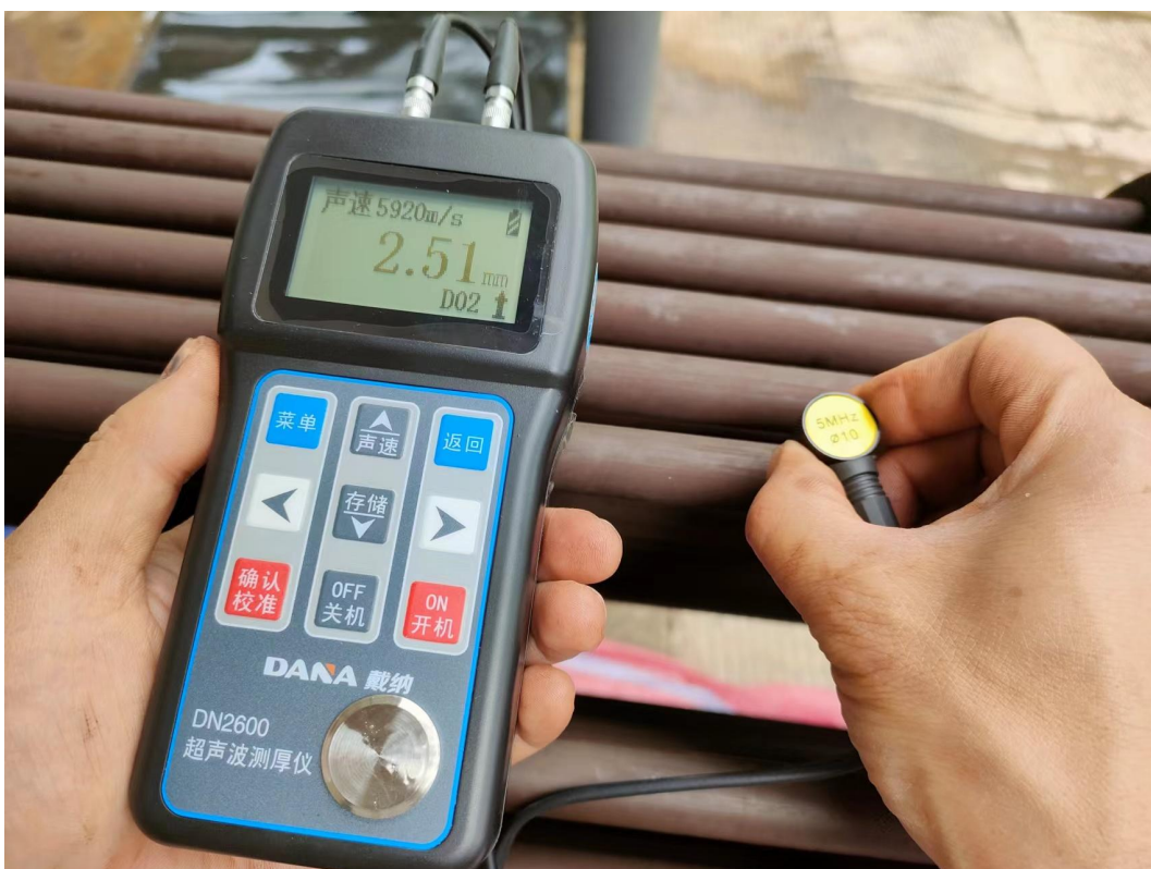
水解器盘管清洗后壁厚检测
