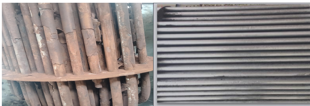
换热管束清洗前后照片
